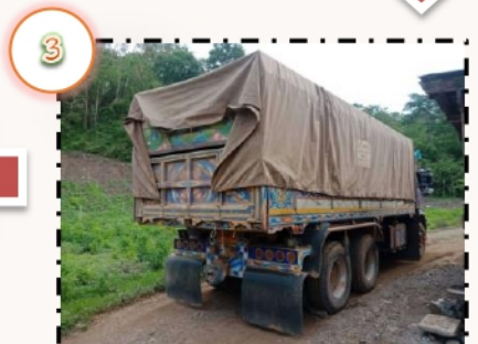
5 ทำการปูแผ่นพลาสติกและปิดคลุมด้วยผ้าใบของขนส่งกากทางแร่และดินปนเปื้อน เพื่อป้องกันการรั่วไหลและหกหล่น
