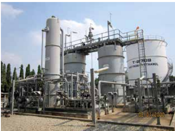
ระบบควบคุมไอระเหยน้ำมันเบนซิน (Vapor Recovery Unit) แบบ Carbon Adsorption
