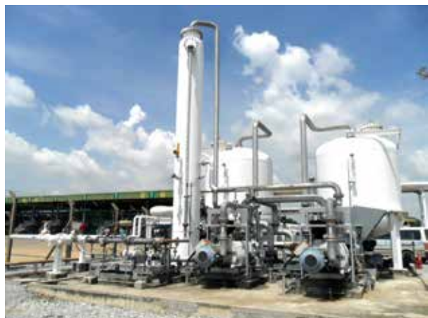
ระบบควบคุมไอระเหยน้ำมันเบนซิน (Vapor Recovery Unit) แบบ Carbon Adsorption
