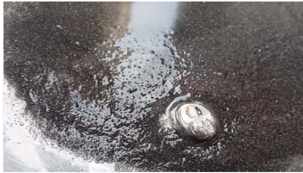
รูปที่ 5 แสดงการใช้ปรอทจับกับแร่ทอง 3
