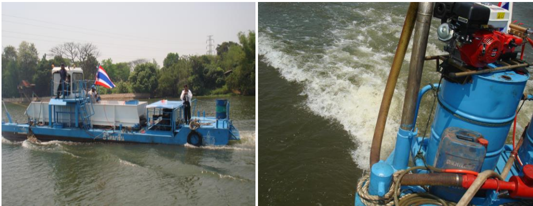
รูปที่ 15 การเติมอากาศในแม่น้ำเจ้าพระยาเพื่อเพิ่มปริมาณออกซิเจนในแม่น้ำ
