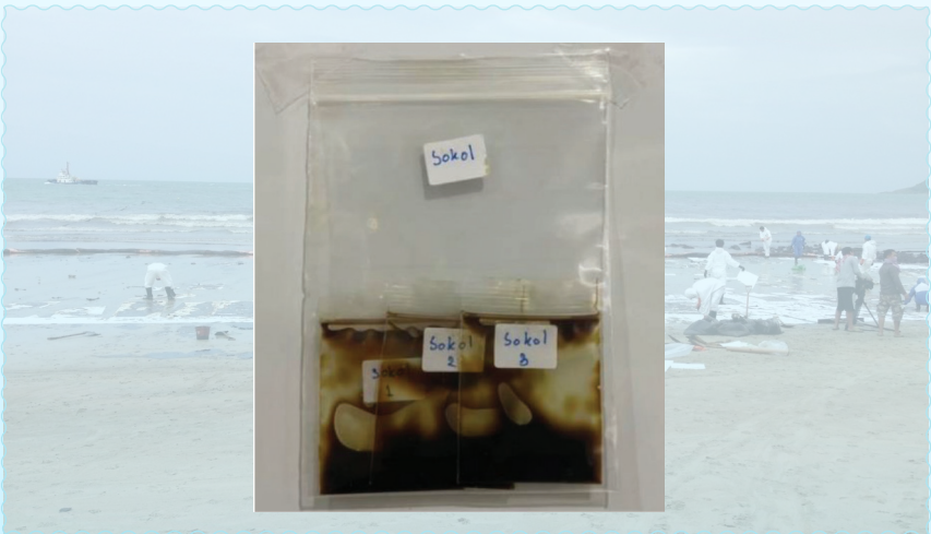
รูปที่ 11 การบรรจุตัวอย่างน้ำมันดิบที่ทำการสุ่มเพื่อวัดด้วยเทคนิคการเรืองรังสีเอกซ์ โดยการบรรจุในถุงพลาสติก Polyethylene zipper bag
