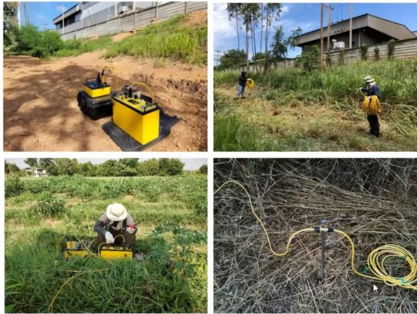
รูปที่ ๔ การสํารวจธรณีฟิสิกส์วัดค่าความต้านทานไฟฟ้าแบบ ๒ มิติ
