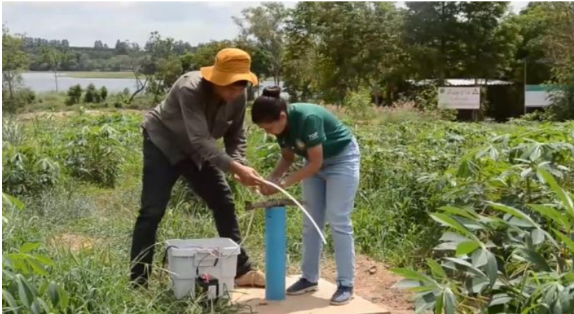
รูปที่ ๗ การวัดระดับน้ำ เก็บตัวอย่างน้ำใต้ดิน และน้ำผิวดิน
