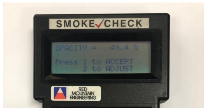
หน้าจอจะแสดงผลค่า opacity ให้ตรวจสอบค่าที่แสดงบนหน้าจอ กับค่าจากใบสอบเทียบเครื่องมือ
