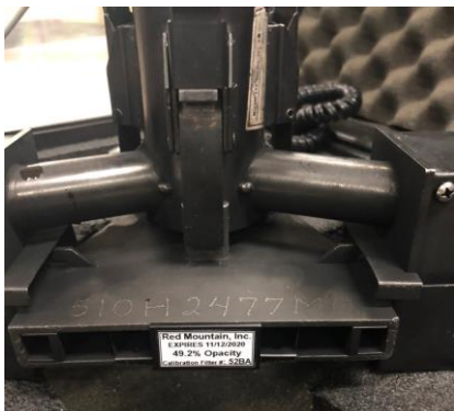
2.ใส่ filter ในช่อง ของหัวตรวจวัดควันดำ (sensor)
