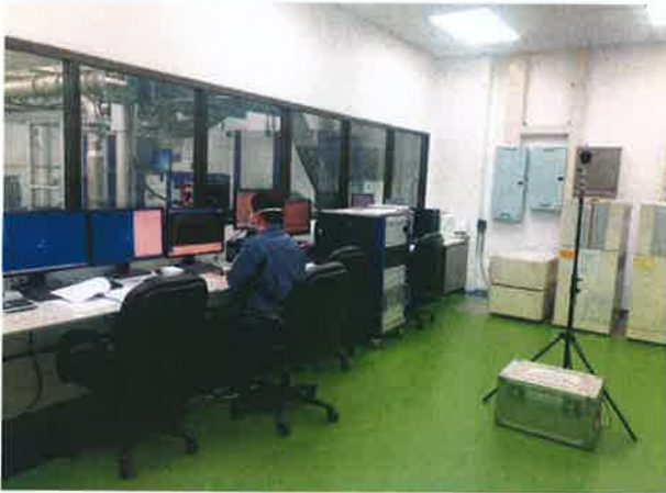
รูปที่ 5 การตรวจวัดระดับเสียงขณะทำงานภายในห้องควบคุมระบบทดสอบมลพิษจากรถยนต์ขนาดเล็ก
