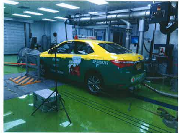
รูปที่ 6 การตรวจวัดระดับเสียงขณะทำงานภายในห้องทดสอบมลพิษจากรถยนต์ขนาดเล็ก
