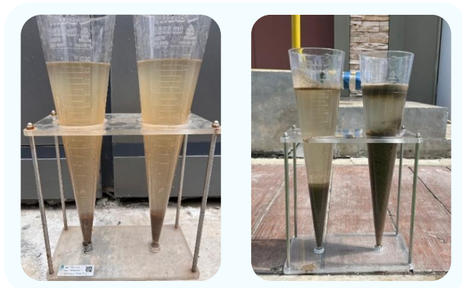
รูปที่ 29 ตัวอย่างการตรวจสอบค่าตะกอนหนักด้วยกรวยอิมฮอฟฟ์
