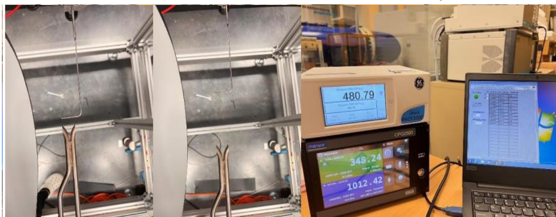
รูปที่ 2 การติดตั้งอุปกรณ์วัดการไหลชนิดท่อพีไอต์แบบเอสเพื่อหาค่า Blockage effect
